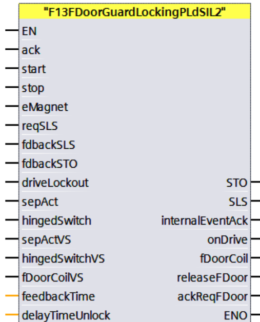
Figure 19-4 FB utilisateur F13DoorGuardLockingPLdSIL2
